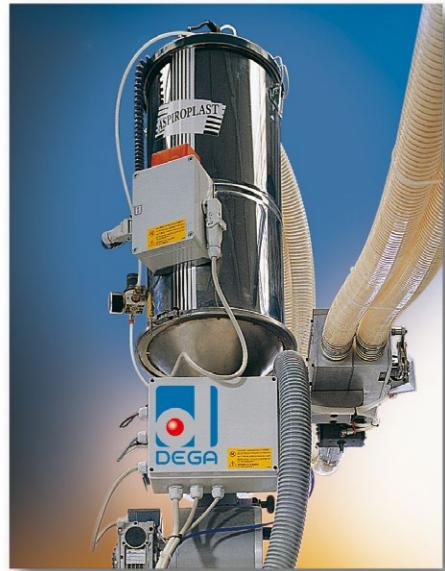
Il sistema è basato sul principio di montare il comune alimentatore su una cella di carico. Ogni ciclone è predisposto per caricare 2 materiali. La cella di carico pesa il I° materiale che entra nel ciclone, al raggiungimento del peso voluto comanda la valvola di selezione e abilita il II° canale di aspirazione per caricare il II° materiale. Raggiunto il peso totale il materiale cade nel miscelatore e viene omogeneizzato per almeno 7 minuti.
