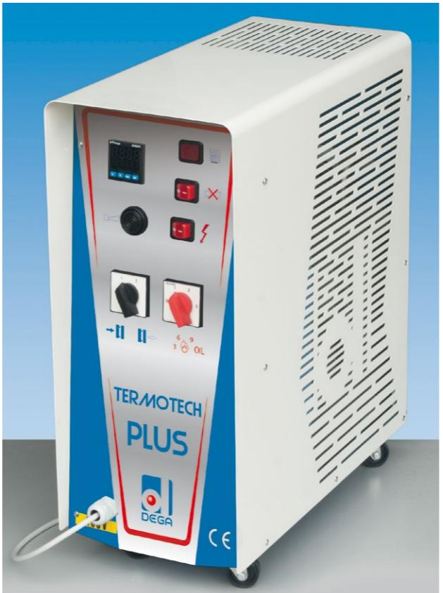
**TERMOTECH PLUS** è la macchina più versatile della gamma; è possibile termoregolare acqua fino a 95° C. ed olio fino a 150° C., in pressione e depressione continua, con potenze variabili tra 3 e 9 Kw. **La Plus è interfacciabile e programmabile col controllo della macchina a cui è abbinata.**
