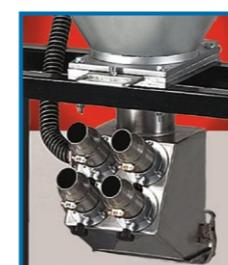
Valvole di fluidificazione per silos e tramezze
