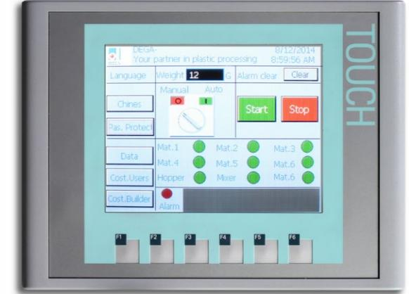
La programmazione e la gestione delle ricette è semplice ed intuitiva, sul controllo touch screen ogni funzione è segnalata con una simbologia che raffigura la parte che si sta programmando, ogni anomalia è raffigurata con la parte in allarme.
